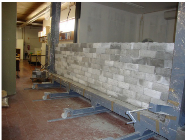
Fig. 1: Parede constituída por blocos de solos e cinzas volantes para ensaios acústicos e térmicos
