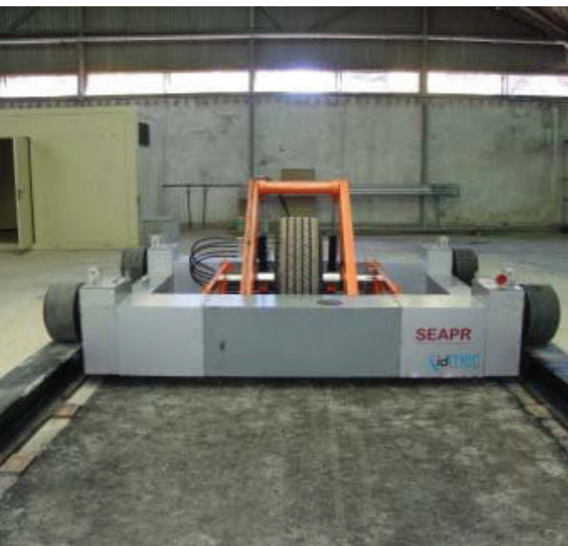
Figura 2: Simulador de tráfego e tenda em tela de PVC para acondicionamento do trecho experimental
